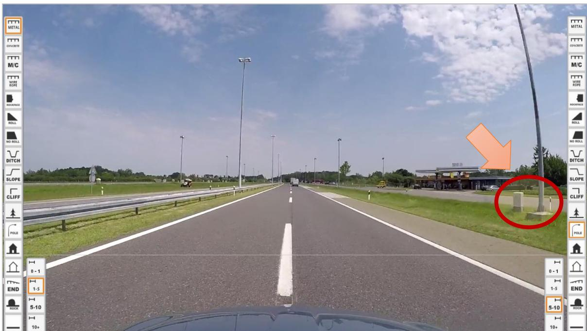
**Slika 13. Primjer opasnog mjesto s nezaštićenim stupom javne rasvjete na desnoj strani ceste, bez postavljene zaštitne odbojne ograde**
